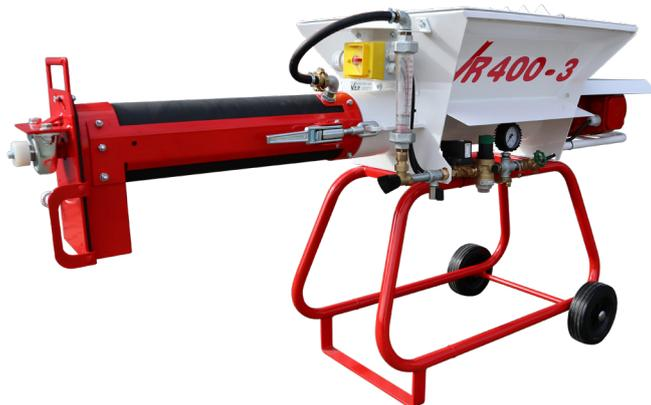
Der Durchlaufmischer **VR400-3** verarbeitet alle marktüblichen Trockenfertigmörtel wie z.B. Mauermörtel, Putze, Feinbeton, Kleber, Spachtel, Estrich. Je nach Bedarf ist es möglich, Sackware oder mittels einer handelsüblichen Trockenförderanlage Silomaterial zu verarbeiten. Durch das Gummimischrohr ist eine vereinfachte Reinigung sowie ein verschleißärmeres Arbeiten möglich.
